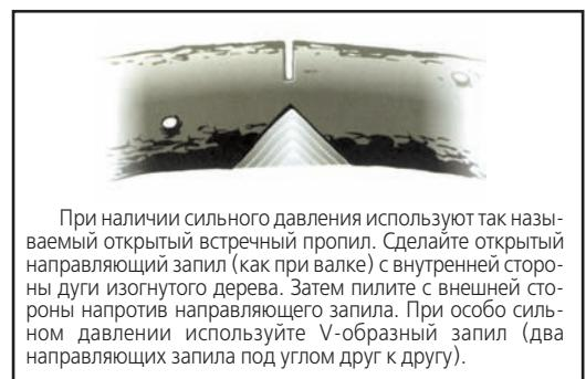
При наличии сильного давления используют так называемый открытый встречный пропил. Сделайте открытый направляющий запил (как при валке) с внутренней стороны дуги изогнутого дерева. Затем пилите с внешней стороны напротив направляющего запила. При особо сильном давлении используйте V-образный запил (два направляющих запила под углом друг к другу).
