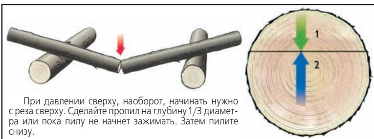
Особую сложность и опасность представляет работа с поваленными ветром деревьями. В них бывает очень большое давление, которое при отпиливании приводит к сильному отскоку дерева. К тому же упавшие деревья часто имеют трещины и повреждены гнилью, поэтому могут переломиться раньше, чем вы закончите пропил. Лучше начать раскряжевку с верхушки, чтобы постепенно уменьшить давление.
