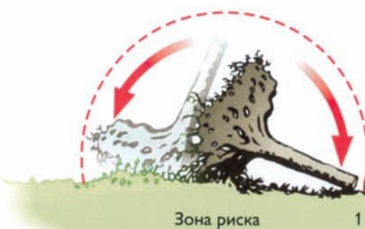
Дерево, вырванное с корнем, нельзя кряжевать от корня. Изогнутые корни запасают очень большую энергию; при снятии нагрузки от поваленного ствола пень может резко вернуться на свое место, придавив находящихся рядом людей. Отступите на 2-3 метра и осторожно пилите, используя открытый или V-образный запил. Потом поднимите бревно вместе с корнем и спилите его на уровне пня.
